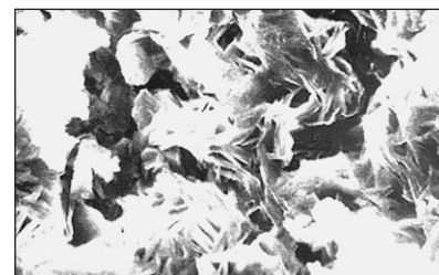
Рис.5. Кристаллики гидросиликата кальция в образце бетона, для приготовления которого использовался шлак, содержащий ванадий.
